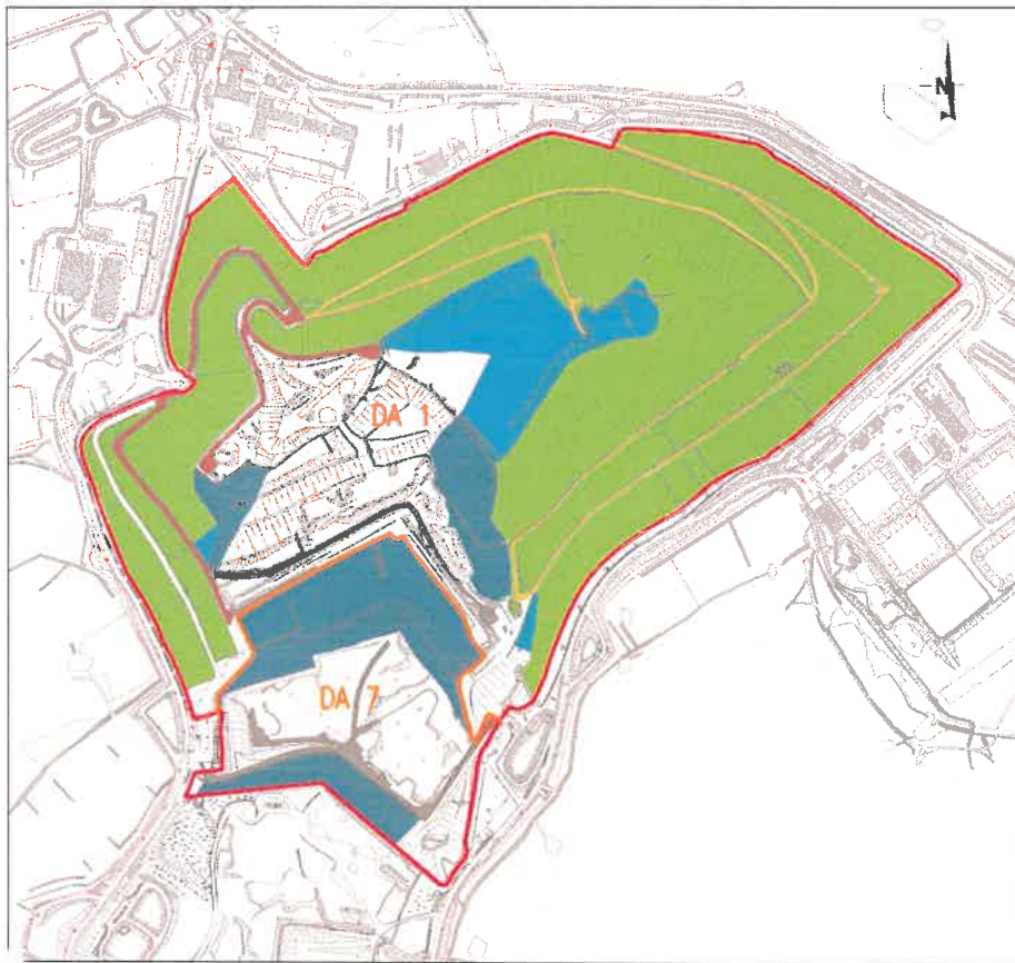
Abbildung 5.1: Ablagerungsbereich der Deponie im Jahr 2014, die weißen Flächen innerhalb der roten Umrandung (Deponiefläche) kennzeichnen die offenen Ablagerungsbereiche [7]
