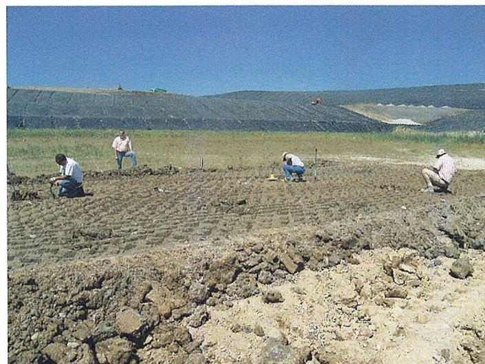
Beprobung der gefrästen und 4 bzw. 5 mal verdichteten Lage
