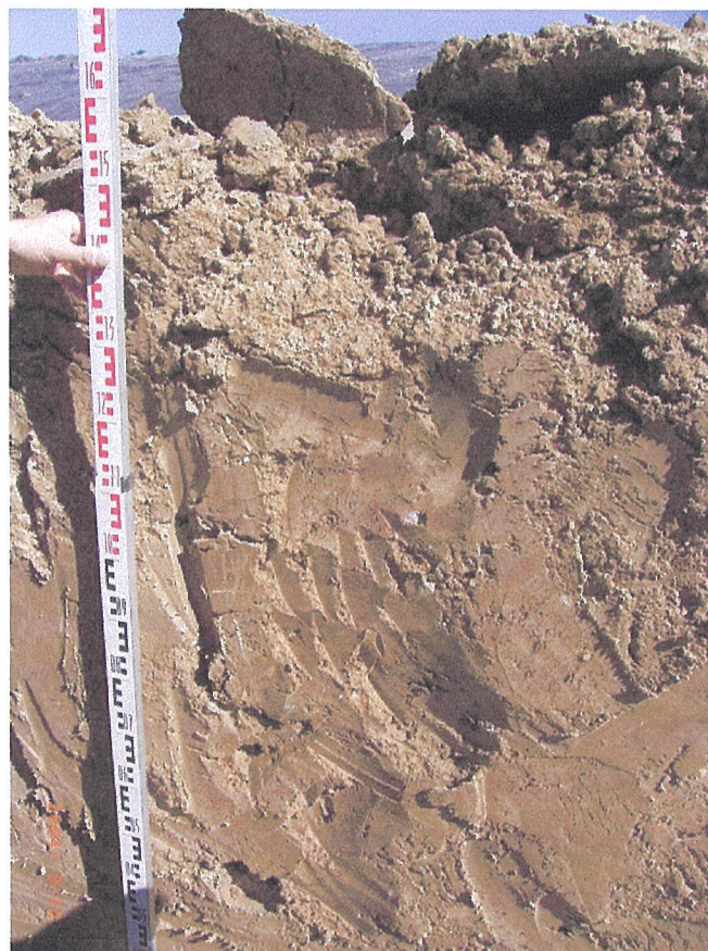
Bild 10: Schurf, kein Lagenübergang erkennbar
