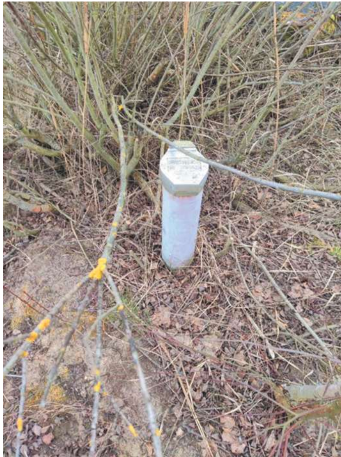
Grundwassermessstelle auf dem Gelände des Kiessandtagebaus Kotzow
