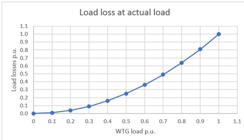
Abbildung 4 2: Transformatorlastverluste – Skalierung.
