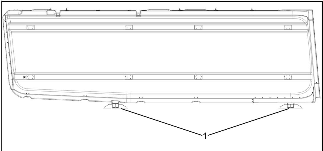
Abb. 1: Maschinenhaus, Ansicht von rechts mit Transportfüßen (1)
