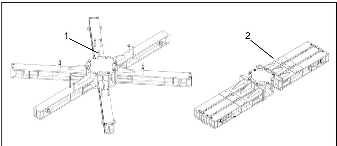
Abb. 9: Transportvorrichtung Nabe (1) und demontiert für Rücktransport (2), Abb. ähnlich
