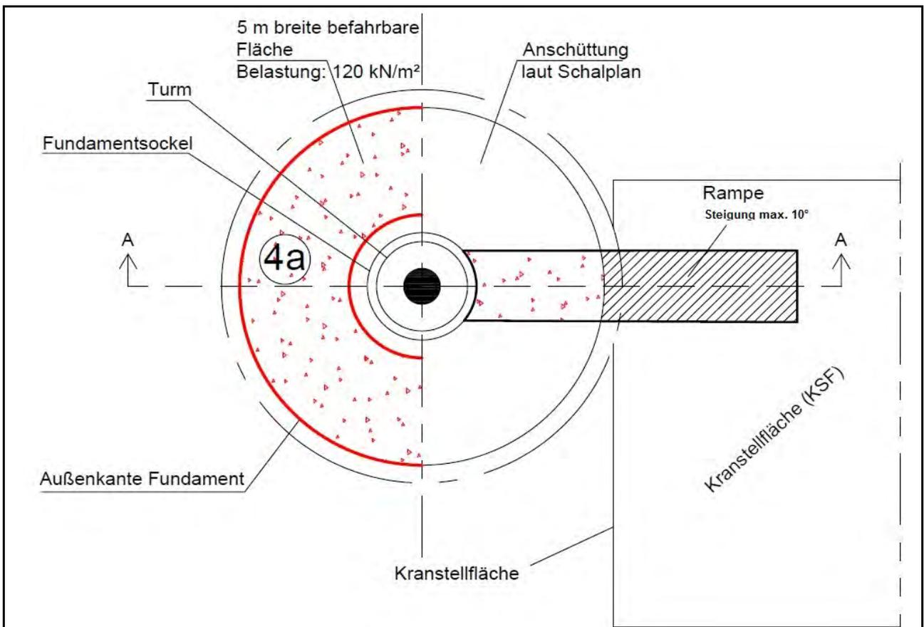
Abb. 24: Fläche um den Turm in Draufsicht (Stahlrohrturm)
