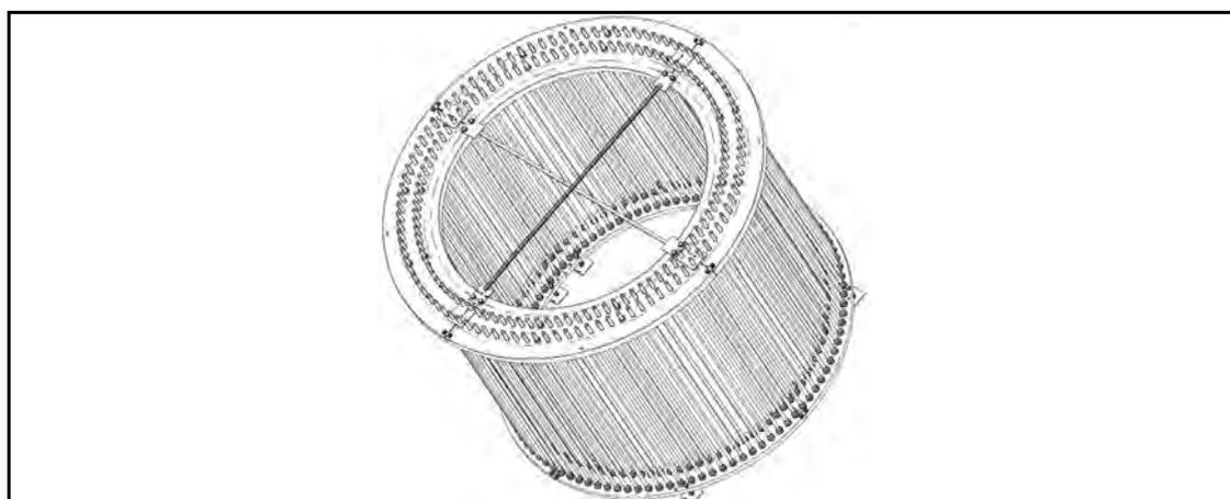
Abb. 10: Beispiel für einen Ankerkorb mit 4 x 50 Ankerbolzen
