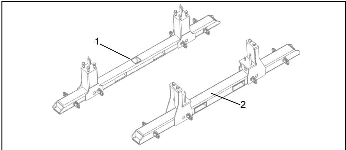
Abb. 7: Transportfüße Maschinenhaus vorn (1) und hinten (2), Abb. ähnlich
