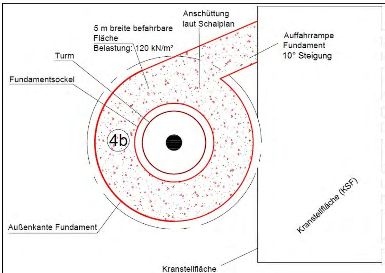
Abb. 25: Fläche um den Turm in Draufsicht (Hybridturm)
