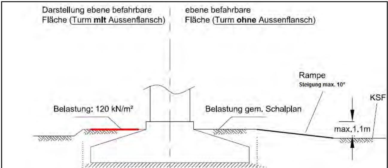
Abb. 23: Fläche um den Turm im Schnitt
