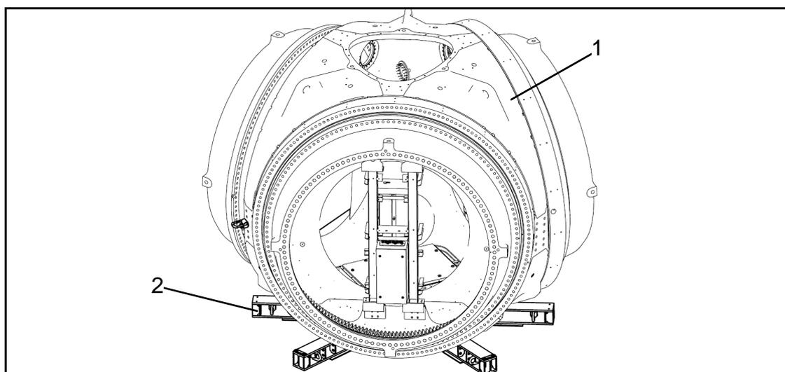
Abb. 4: Rotornabe (1) auf Transportgestell (2) im Transportzustand
