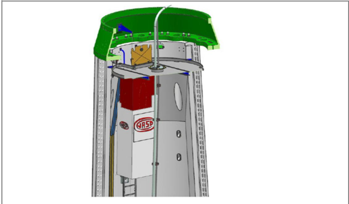
Abb. 3: JASO-Hebebühne für Beton- und Hybriddturm (TC100N und TC168N)
