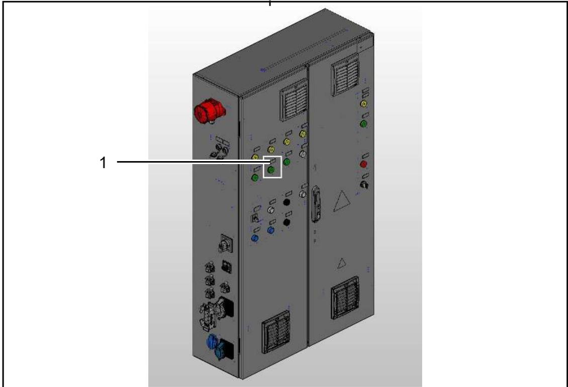
Abb. 20: Position der Signalleuchte
