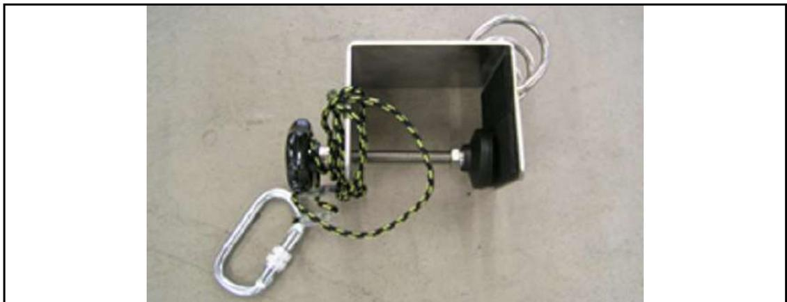
Abb. 26: U-förmiger Kantenschutz
