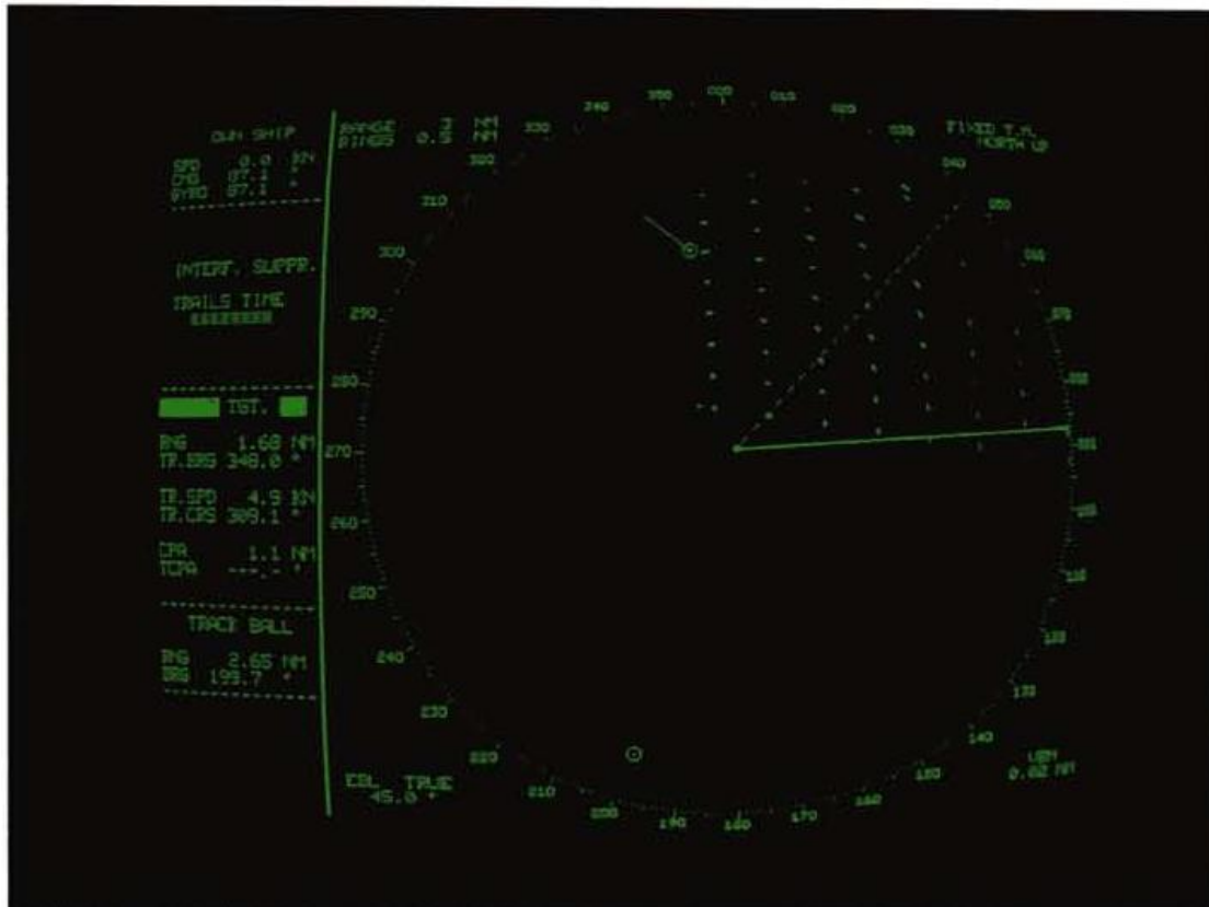
Abbildung 19: Vom Radar akquiriertes Ziel hinter einer Anzahl von Offshore Bauwerken [// 12, S.8]
