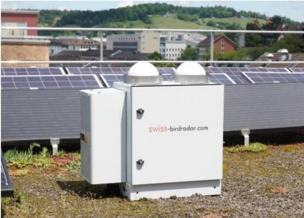
Abbildung 9: Das FaunaScan MR2 ist ein X-Band Radar mit frequenzmodulierter kontinuierlicher Radarwelle der neuesten Generation.
