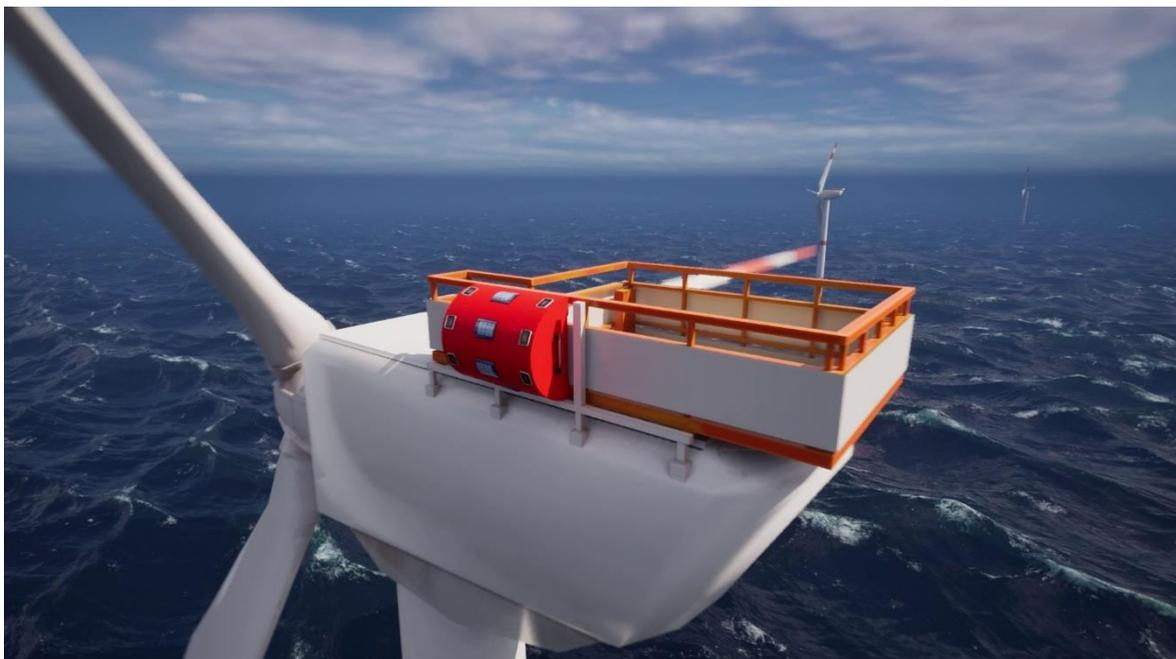
Abbildung 5: AVES Offshore-Kamerasystem, Trägermodul am Helihoist installiert (3D-Darstellung).
