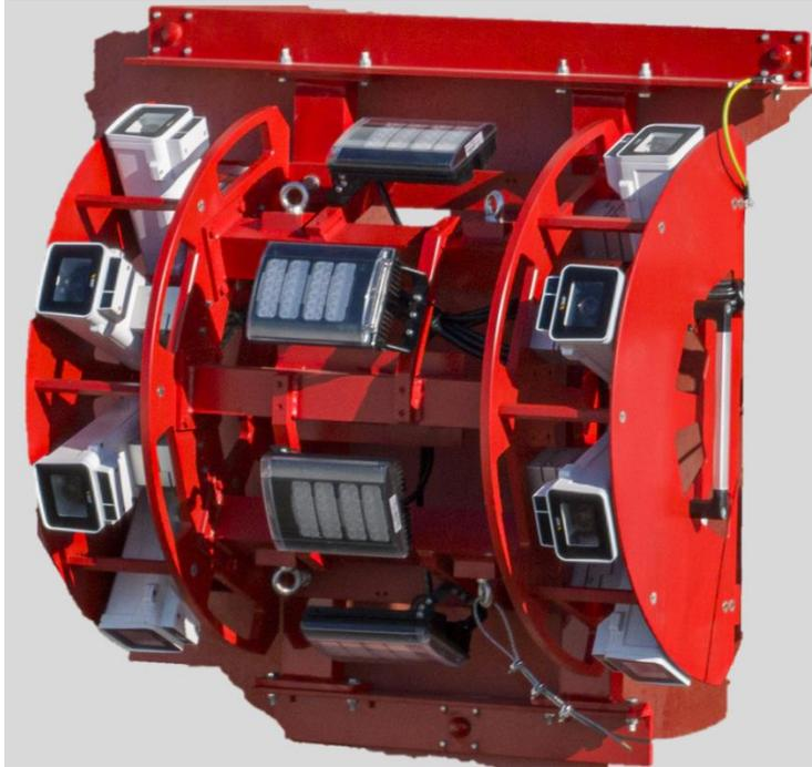
Abbildung 4: Prototyp eines AVES Offshore-Kamerasystems mit vier parallel ausgerichteten Kamerapaaren, das derzeit im Rahmen eines Forschungsprojekts in einem Windpark an der Küste eingesetzt wird.
