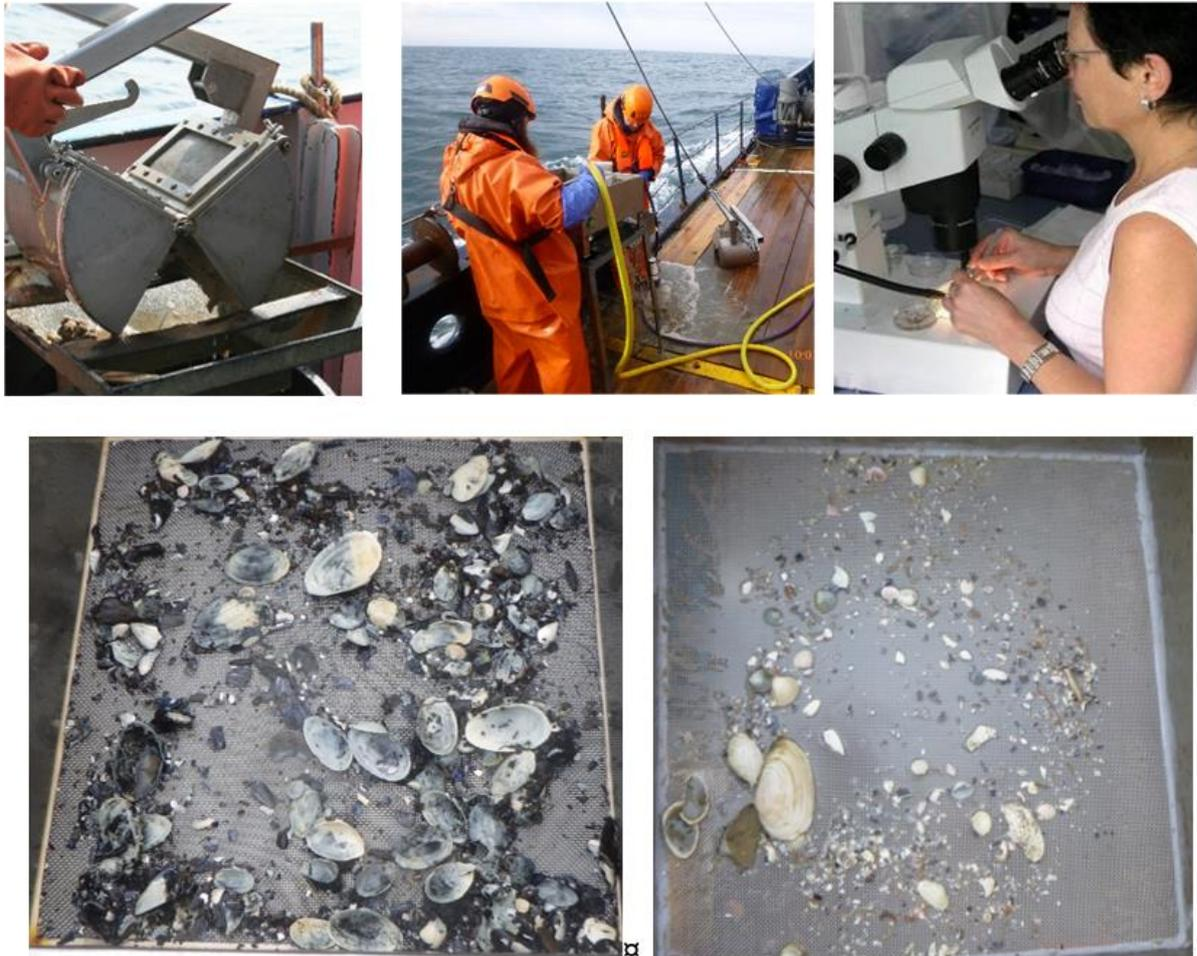
**Abb. 5:** *Probenahme mittels van-Veen-Greifer zur Erfassung der Infauna (links oben); Aufschwemmung des Sedimentes (Mitte oben); Bestimmung der Infauna im Labor des IfAÖ (rechts oben); typischer Siebrest im OWP „Gennaker“ im Herbst 2023 (Station P014; links unten) und im Frühjahr 2024 (Station P306; rechts unten).*
