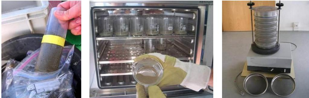
**Abb. 4:** *Sedimententnahme und -bearbeitung. Links: Stechzylinder zur Sedimententnahme aus dem van-Veen-Greifer und Transportbeutel; Mitte: Trocknung von Sedimenten im Muffelofen; Rechts: Siebturm zur Korngrößenfraktionierung.*
