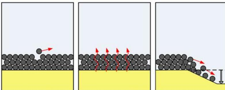
Figure 1: Schematisierung der externen Stabilität (links), Schnittstellenstabilität (Mitte) und Flexibilität (rechts)
