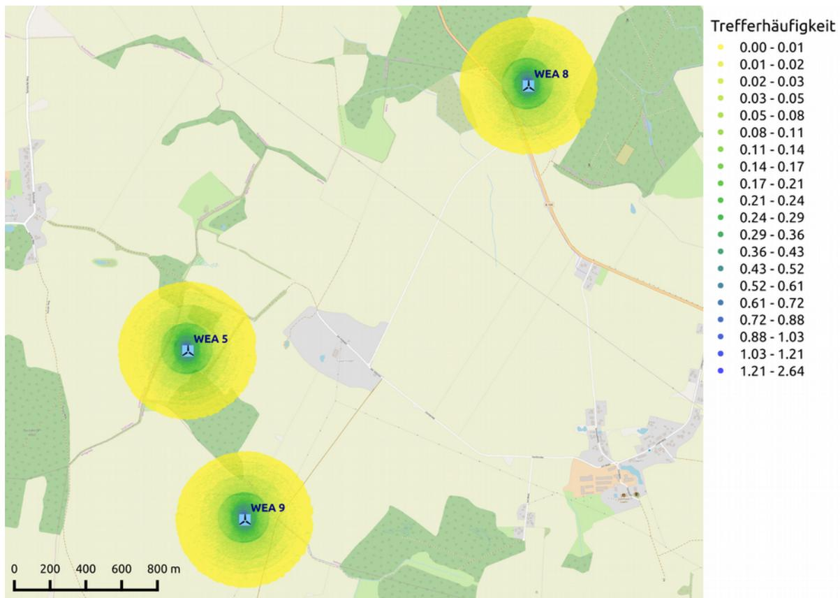
**Abbildung A.1.1:** Trefferhäufigkeiten von Blattbruchstücken pro Rasterfläche ( $25\text{m}^2$ ) in einer Millionen Jahren in der Umgebung der WEA 5, 8 und 9 vom Typ Vestas V150 5.6MW, NH 166m am Standort Rehna-Falkenhagen (Karte /1.4/).
