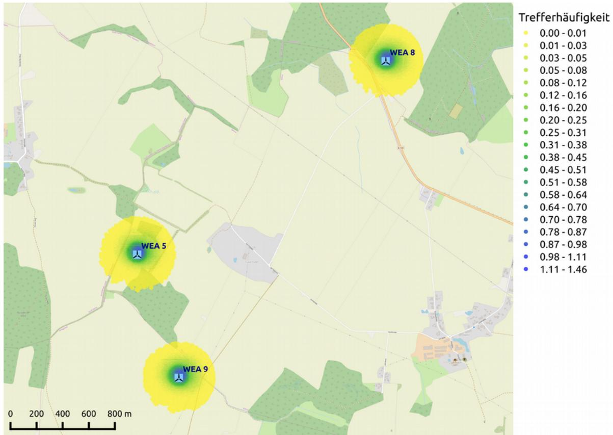
**Abbildung B.1.1:** Trefferhäufigkeiten von Eisstücken pro Rasterfläche (16m<sup>2</sup>) und Jahr in der Umgebung der WEA 5, 8, 9, 11 und 12 am Standort Rehna-Falkenhagen (Karte /1.4/).
