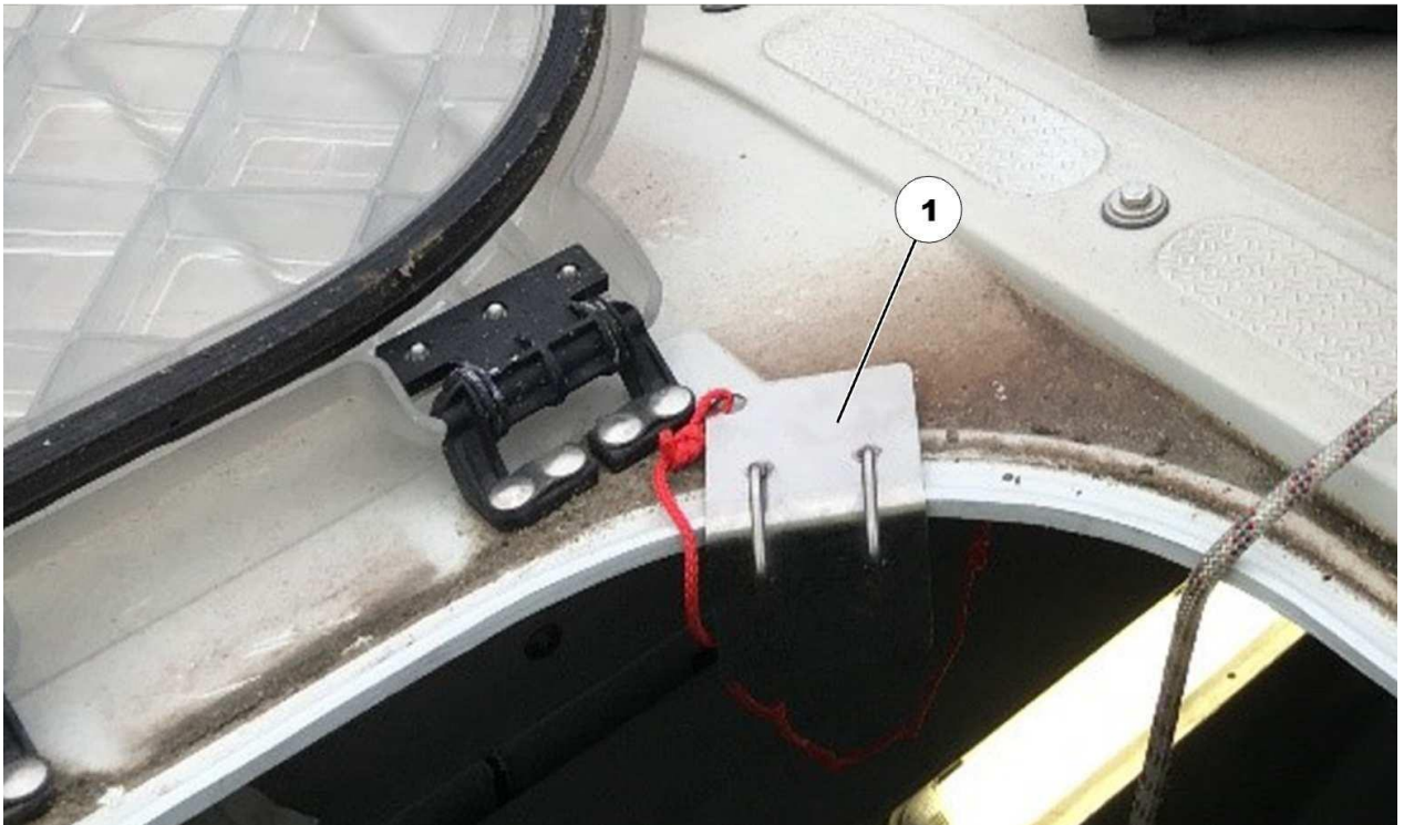
Abbildung 5.15: Kantenschutzvorrichtung am Rand der Dachluke
