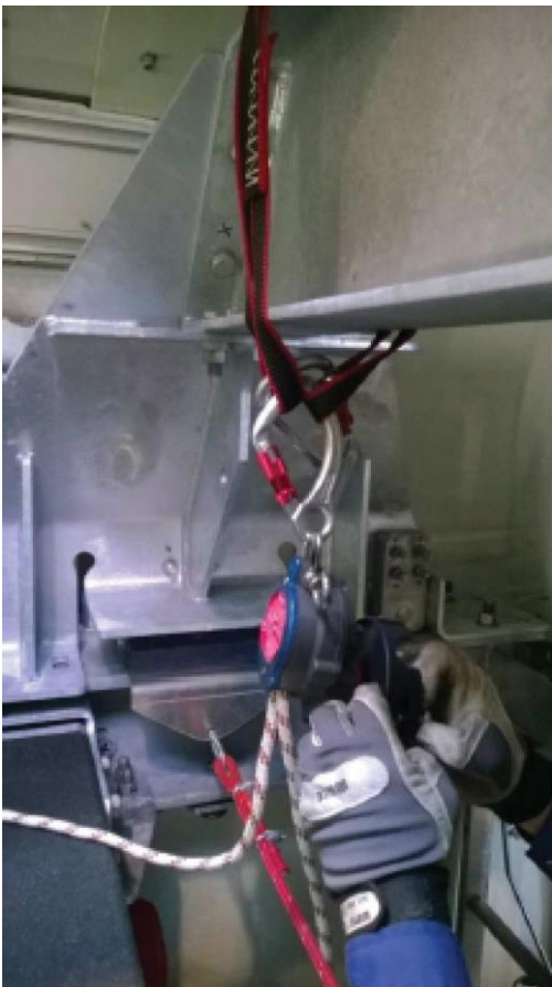
Abbildung 5.23: Am internen Ausleger befestigte Abstiegsvorrichtung
