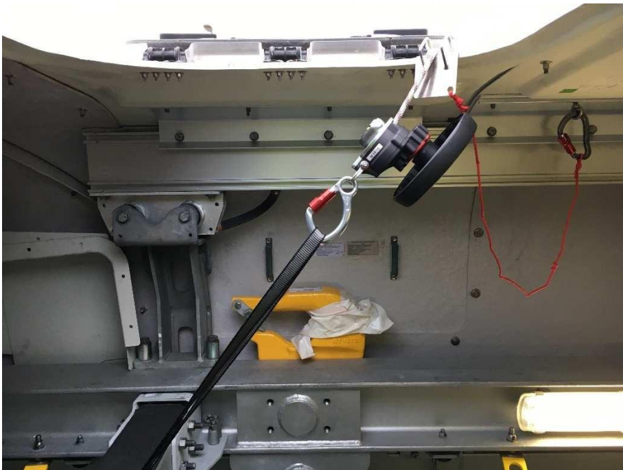
Abbildung 5.16: Abstiegsvorrichtung und Schlinge um den Querträger
