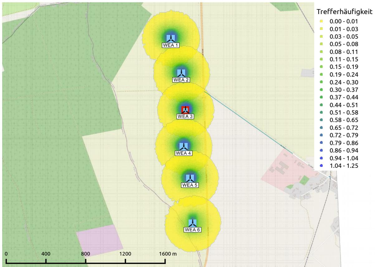
**Abbildung B.1.1:** Trefferhäufigkeiten von Eisstücken pro Rasterfläche ( $16\text{m}^2$ ) und Jahr in der Umgebung der WEA 1 - 5 am Standort Wendisch-Priborn und für eine Azimut-Position nach Abschaltung durch die Eiserkennung für die WEA 6 von  $89^\circ$  (Karte /1.4/).
