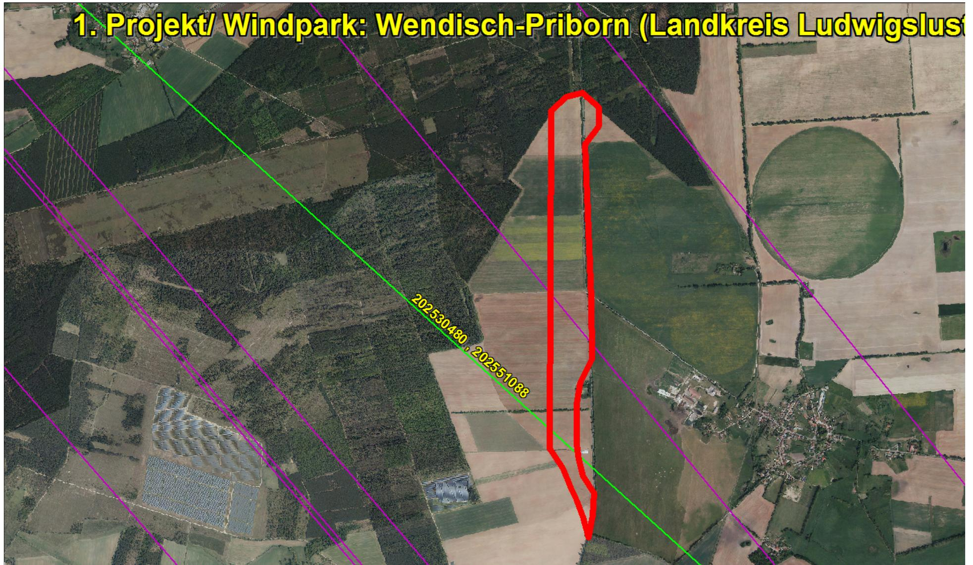
Die farbige Linie versteht sich als Punkt-zu-Punkt-Richtfunkverbindung der Telefónica Germany GmbH & Co. OHG und E-Plus Service GmbH. Das Plangebiet ist im Bild mit einer dicken roten Linie eingezeichnet.
