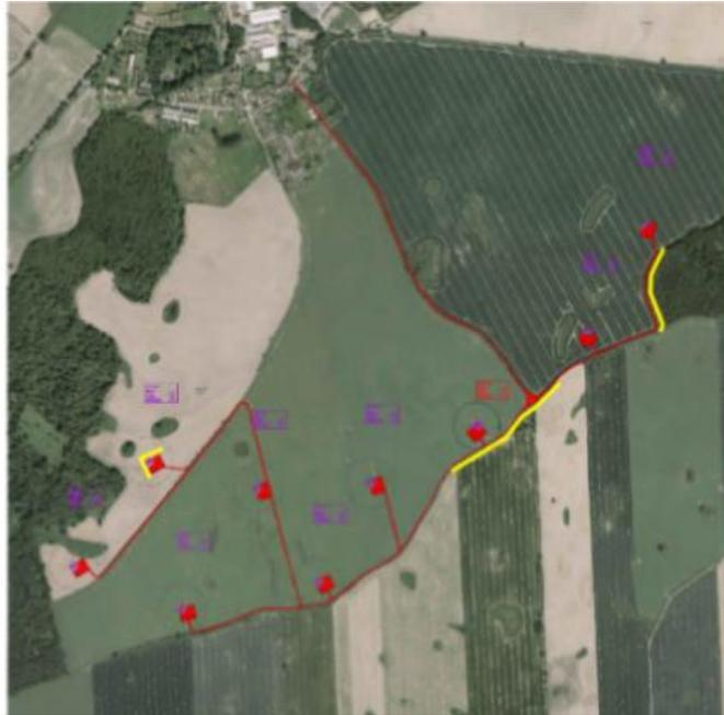
Der Landweg von Herzberg nach Granzin wird nach der Anlieferung der Großkomponenten und Inbetriebnahme der Windenergieanlagen als dauerhaft öffentlich-rechtliche Erschließung für Rettungs- und Wartungsfahrzeuge bereitstehen. Er wird dazu bei Bedarf und in Abstimmung mit der Gemeinde Obere Warnow ertüchtigt.
