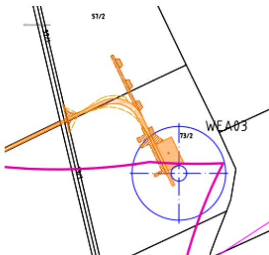
Abbildung 5: Schema der Flächenzuordnung am Beispiel der Anlage WEA 03
