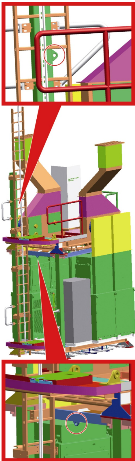
Abbildung 23: Anschlagpunkte im Umrichterbereich
