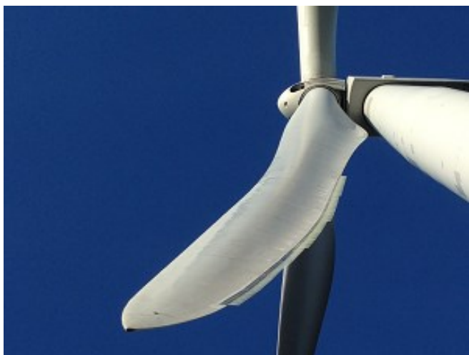
Abb. 1: Serrations (gezackte Blatthinterkanten) an einer WEA
