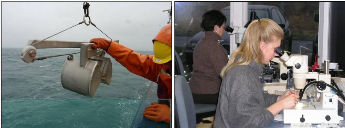
**Abb. 13:** Probenahme mittels Van-Veen-Bodengreifer zur Erfassung der Infauna (links) und quantitative Erfassung der Infaunaorganismen im Labor des IfAÖ, Neu Broderstorf (rechts).
