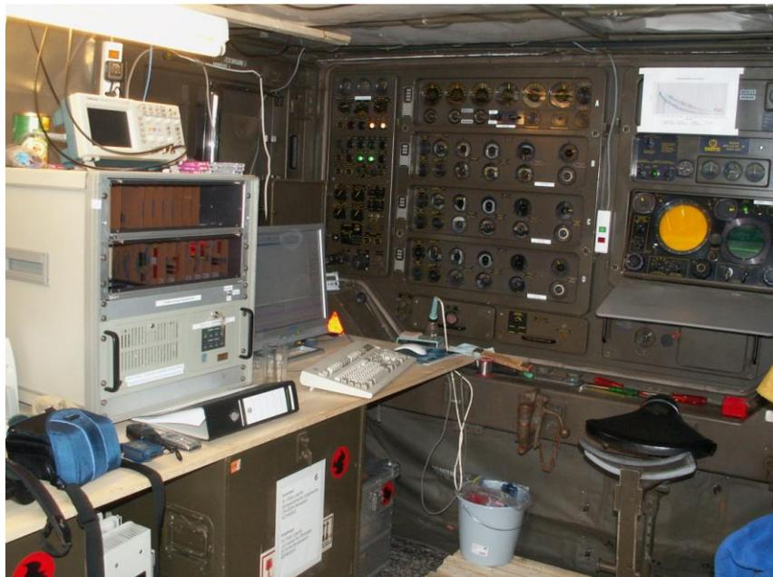
**Abb. 10: Bedienungselemente des Radars und der Datenerfassungsanlage.**
