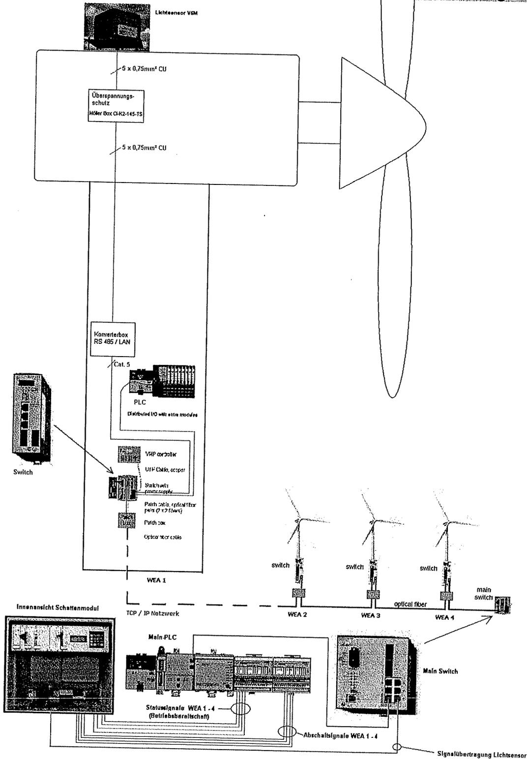
Abbildung 11-1: Prinzipskizze „Einbindung in die VestasOnline™ Fernüberwachung“
