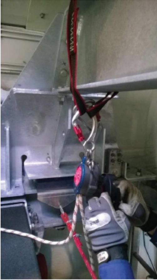
**Abbildung 5.23: Am internen Ausleger befestigte Abstiegsvorrichtung**
