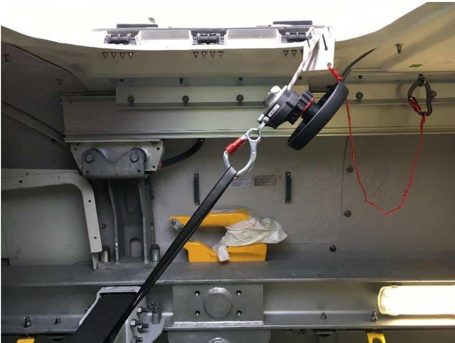
**Abbildung 5.15: Abstiegsvorrichtung und Schlinge um den Querträger**
