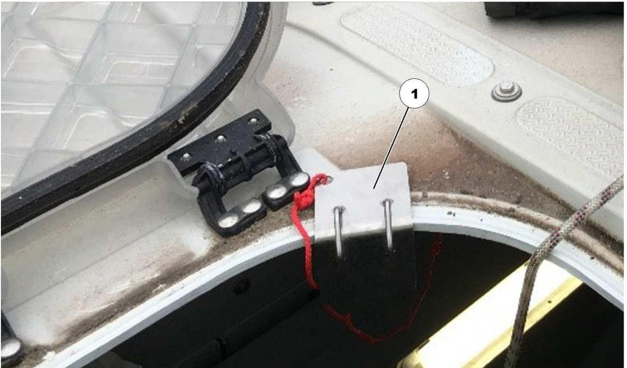
**Abbildung 5.14: Kantenschutzvorrichtung am Rand der Dachluke**
