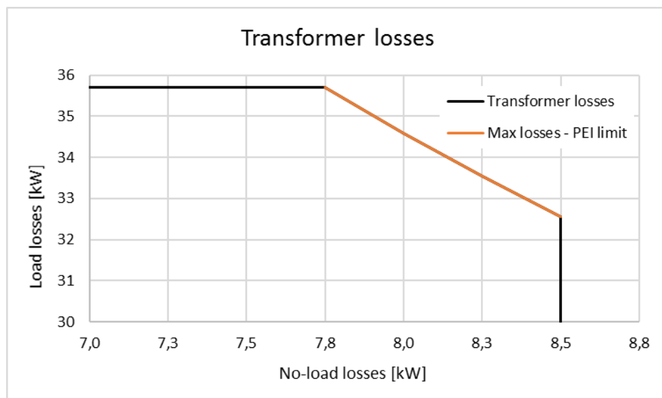
Abbildung 4-1 Transformatorverluste – zulässiger Bereich
