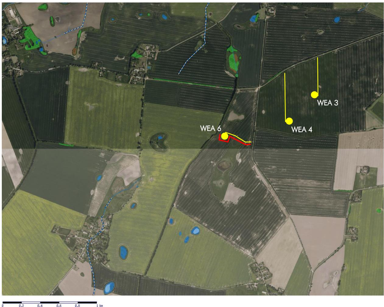
Abbildung 22: Anlagenstandorte (gelbe Punkte) einschl. Zuwegung (gelbe Linien) im Kontext der Fließ- und Standgewässerstruktur (blau, blau gestrichelt) und geschützter Biotope (grün, braun und blau). Die rote Linie zeigt den zu empfehlenden Verlauf eines Amphibienzauns im Bereich der WEA 6, Erläuterung im Text. Kartengrundlage: Kartenportal Umwelt M-V 2020.
