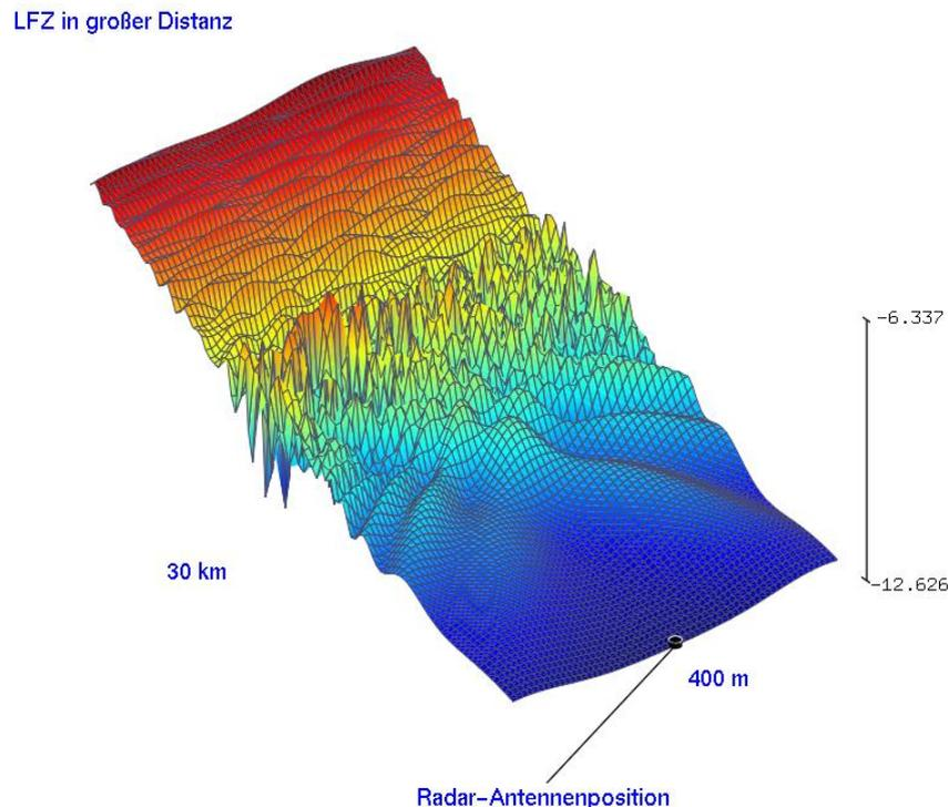
Abbildung 10: Reflexions- und Streufeldausbildung für die Anordnung T3 im Einflussbereich der Radaranlage Elmenhorst
