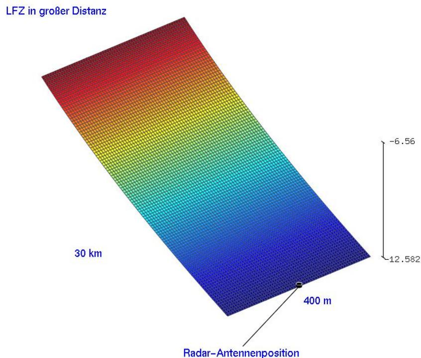
Abbildung 7: Das dargestellte Raumgebiet mit einer Elevation von 0,2° ohne WEA-Einfluss in der Konturdarstellung für die Betriebsfrequenz des Radars Elmenhorst
