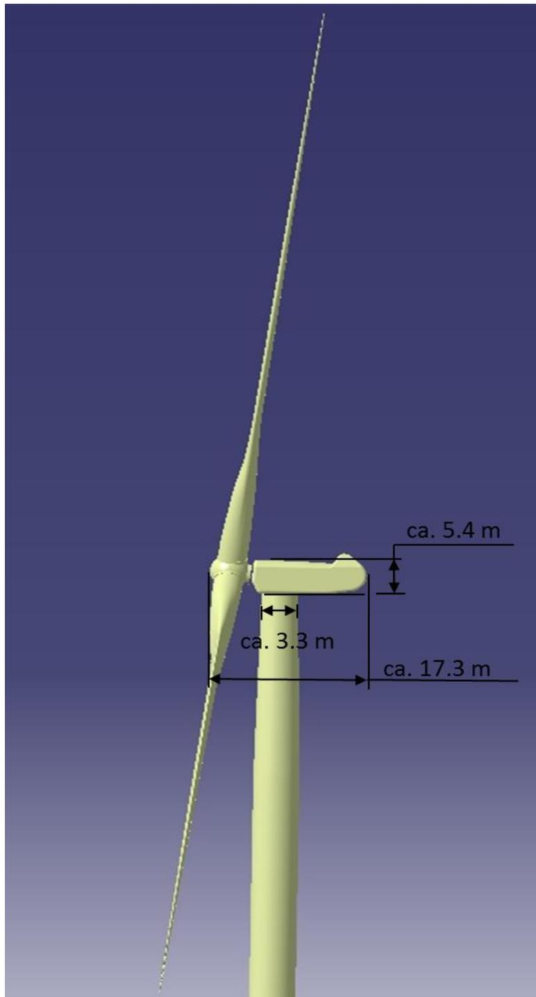
Abbildung 1: Schematische Objektgeometrie für die geplante WEA-Bauform Nordex N149 mit ca. 149 m Rotor
