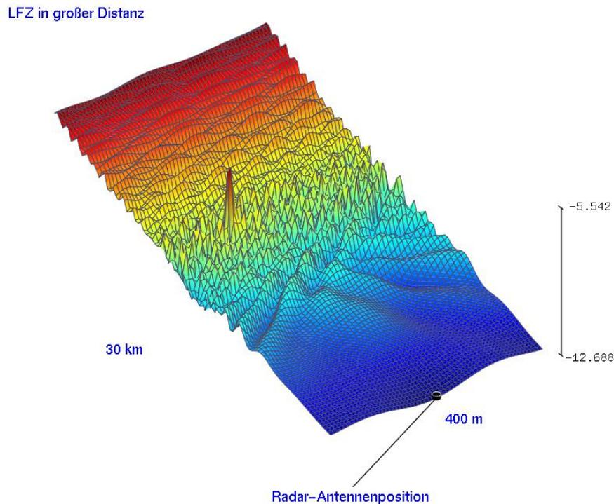
Abbildung 11: Reflexions- und Streufeldausbildung für die Anordnung T4 im Einflussbereich der Radaranlage Elmenhorst
