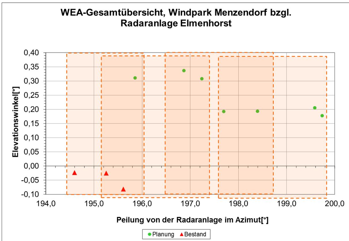
Abbildung 13: Perspektive zur Gondelanordnung gemäß Azimut und Elevation für die Position des Radars Elmenhorst. Die Bereiche der analysierten Teilanordnungen sind durch farbige Flächen gekennzeichnet.
