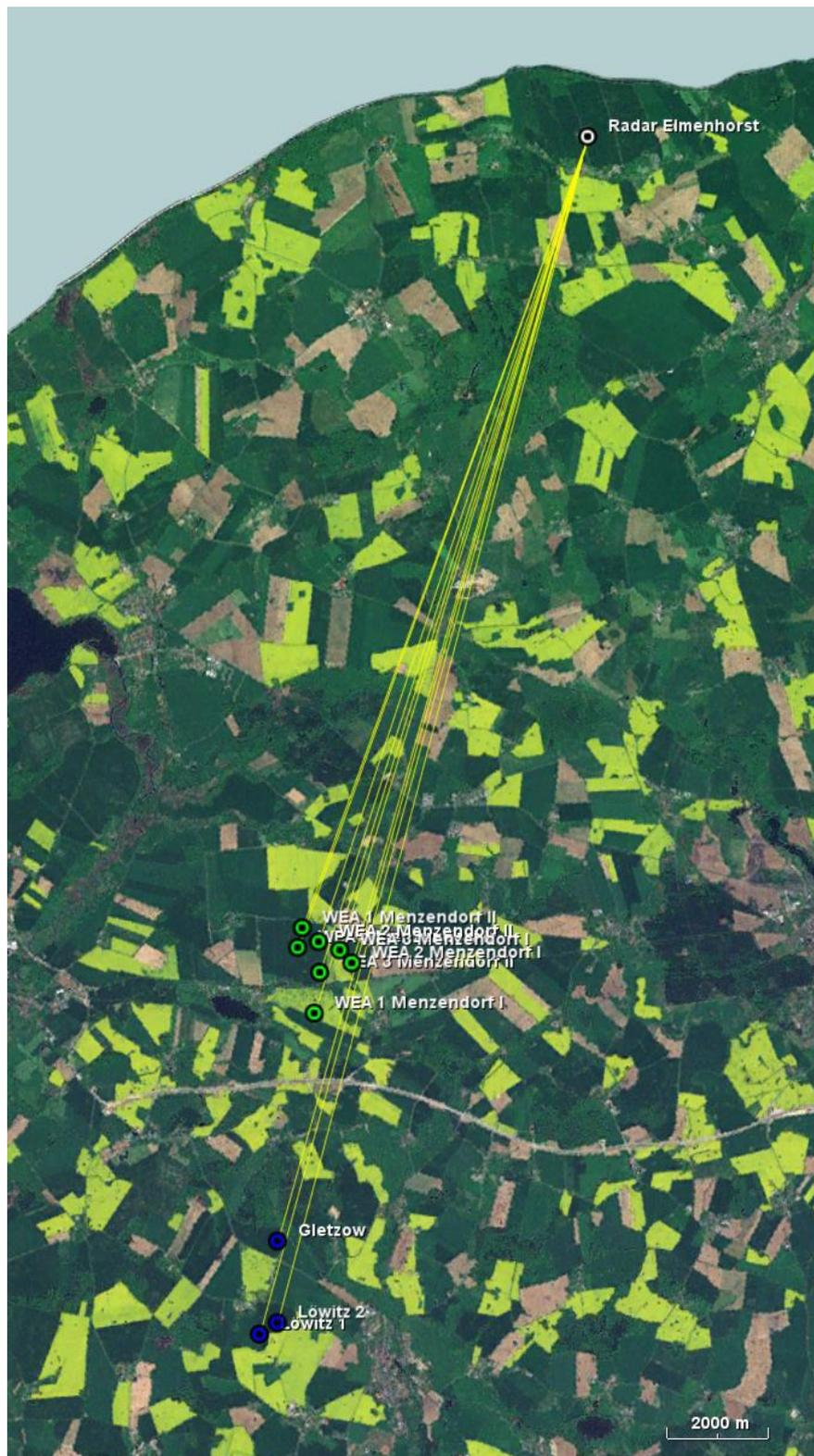
Abbildung 4: Luftaufnahme des Windparks Menzendorf mit den geplanten Windenergieanlagen (grün) sowie der relevanten Vorbelastung (blau). Die Einstrahlungsrichtungen bzgl. der Radaranlage Elmenhorst sind gelb dargestellt.
