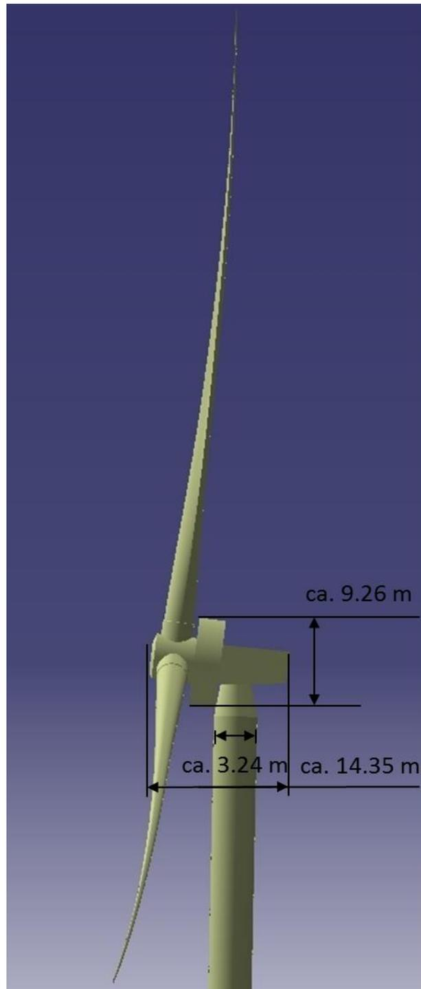
Abbildung 3: Schematische Objektgeometrie für die geplante WEA-Bauform Enercon E-138 EP3 mit ca. 138 m Rotor
