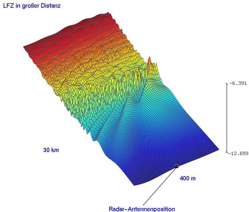
Abbildung 8: Reflexions- und Streufeldausbildung für die Anordnung T1 im Einflussbereich der Radaranlage Elmenhorst
