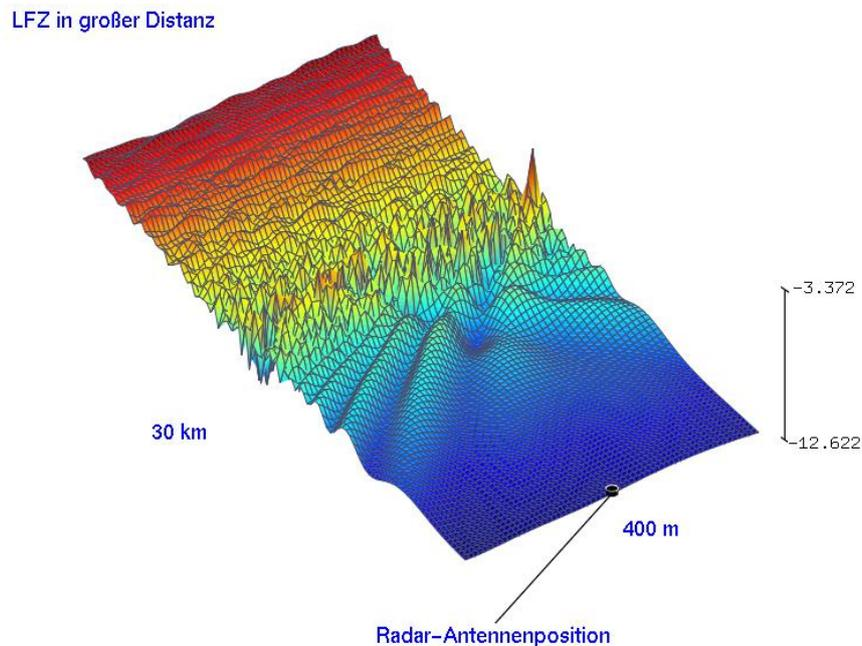
Abbildung 9: Reflexions- und Streufeldausbildung für die Anordnung T2 im Einflussbereich der Radaranlage Elmenhorst
