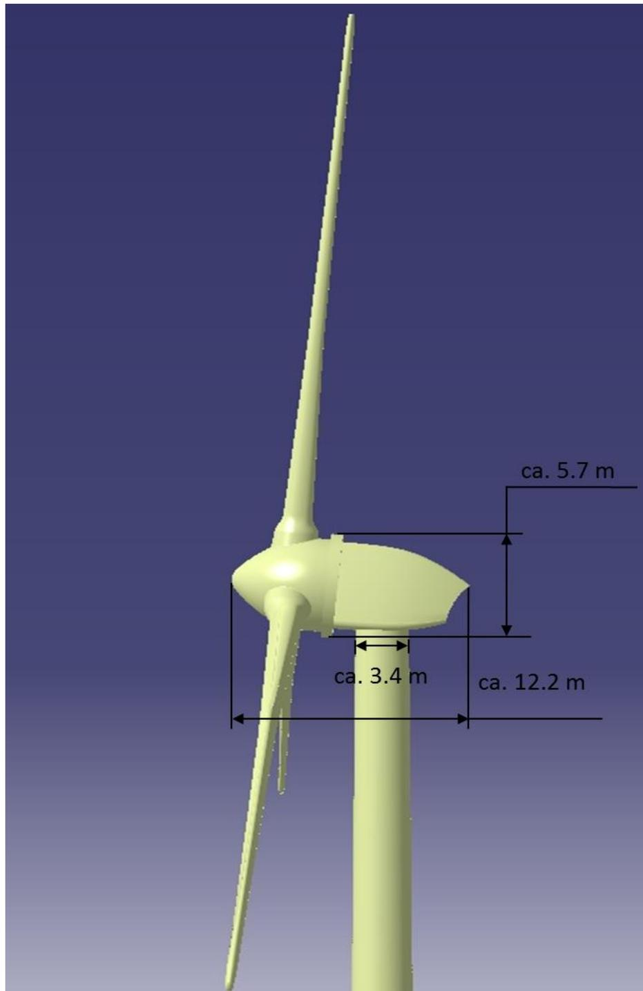
Abbildung 2: Schematische Objektgeometrie für die geplante WEA-Bauform Lagerwey L147 mit ca. 147 m Rotor
