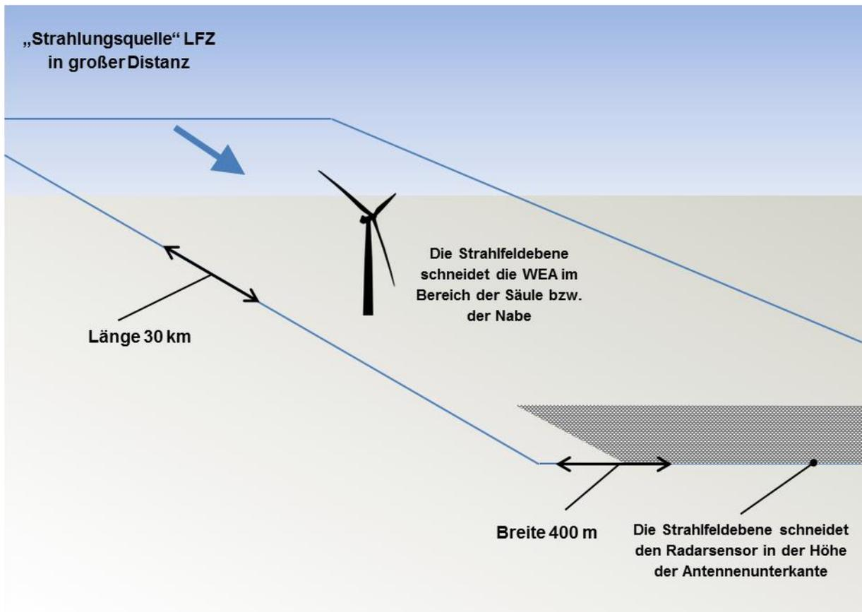
Abbildung 5: Anordnung von Radar und WEA sowie Lage des in dieser Untersuchung dargestellten Luftraums mit einer Ausdehnung von (hier) 30 km x 400 m Breite. Das Lfz wird in einer Distanz von bis zu 130 NM angenommen.
