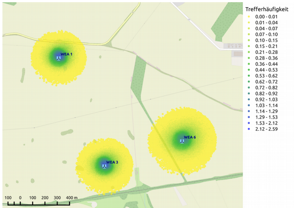
Abbildung B.1.1: Trefferhäufigkeiten von Eisstücken pro Rasterfläche (16m 2 ) und Jahr in der Umgebung der WEA 1, 3 und 6 am Standort Menzendorf (Karte /1.4/).
