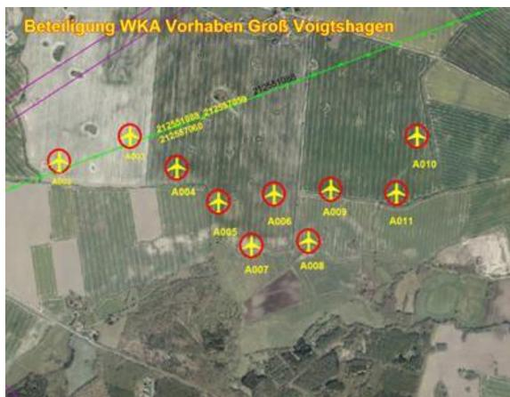
Die farbige Linie versteht sich als Punkt- zu-Punkt-Richtfunkverbindungen der Telefónica Germany GmbH & Co. OHG. Das Plangebiet ist im Bild mit gelben WEA's eingezeichnet.
