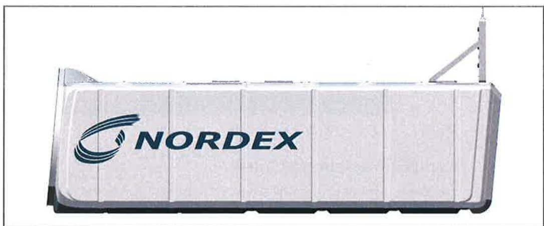
Abb. 5: Seitenansicht Maschinenhaus mit kleinteiligen Seitenteilen
