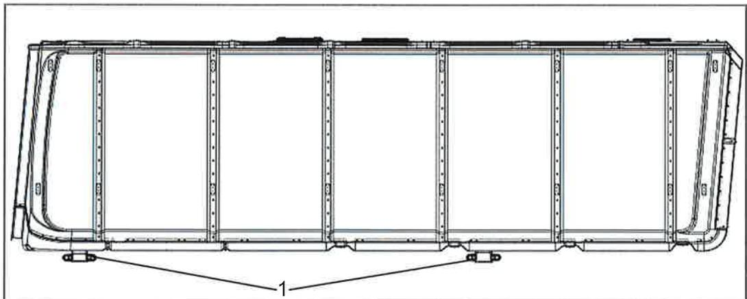
Abb. 1: Beispieldarstellung Maschinenhaus, Ansicht seitlich mit Transportfüßen (1)
