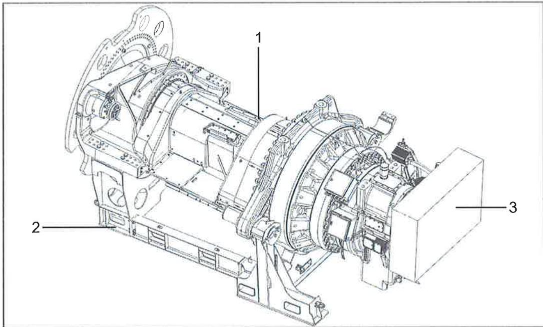
Abb. 3: Bsp. für Triebstrang (1) auf Transportgestell (2) mit Holzabdeckung (3)
