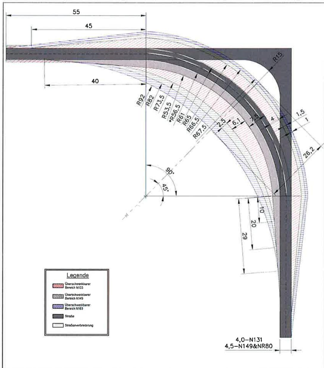
Abb. 14: Minimaler Ausbau 90°-Kurve allgemein, Darstellung ohne Einsatz einer zusätzlichen Schlepplilfe
