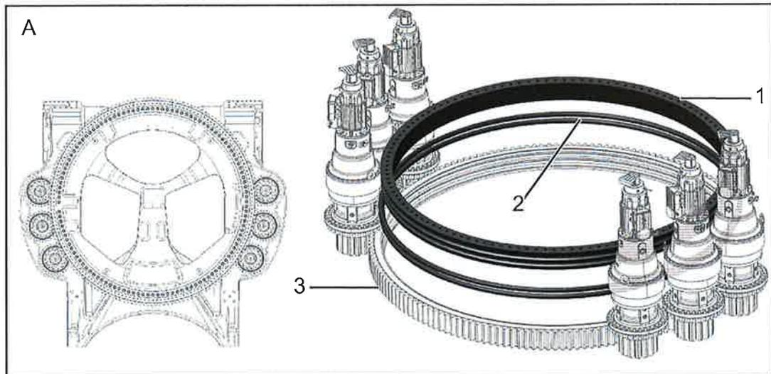
Abb. 4: Azimutlagerbereich mit Blitzstromableitung; Ansicht von unten (A)
