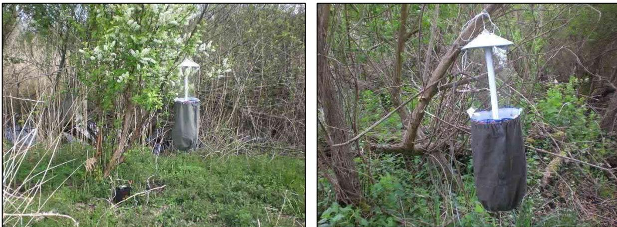
Abbildung 5: Im Gelände aufgehängte Lichtfallen nach WEBER mit 15 Watt superaktinischen Leuchtstoffröhren
