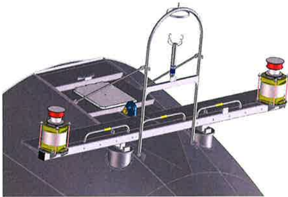
Abb. 1: Befuerung auf der Gondel EP1, EP2 und EP4
