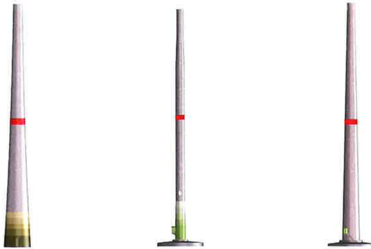
Abb. 7: Farbliche Kennzeichnung am Turm, beispielhafte Darstellung
