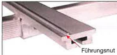
Die Führungsnut soll eine falsche Ausrichtung des Läufers verhindern. Die Führungsnut muss sich auf der linken Seite befinden.
