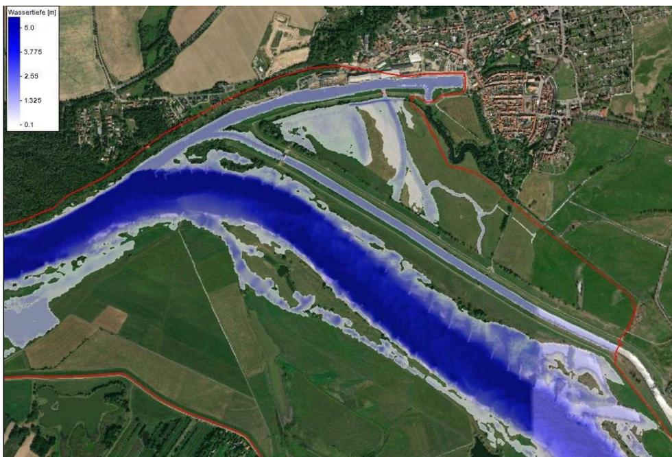
Abbildung 6-1: Überflutungsfläche  $Q = 1000 \text{ m}^3/\text{s}$  (IWU, 2021)
