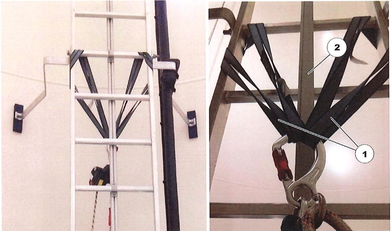
**Abbildung 5.22: Abstiegsvorrichtung mit zwei Schlingen an der Leiter befestigt**
