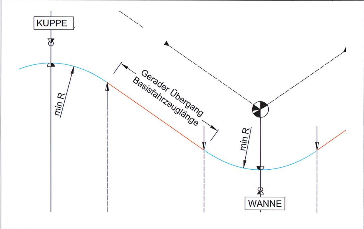
Hybridturm: Abweichend zu den o.g. sind andere Werte während des Bauabschnittes Fundament- und Betonturmbau möglich, Minimumradius von 250 m und Basisfahrzeuglänge von 25m.
