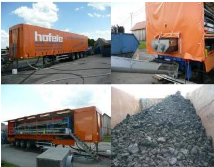
Mobile Kammerfilterpresse im Einsatz
