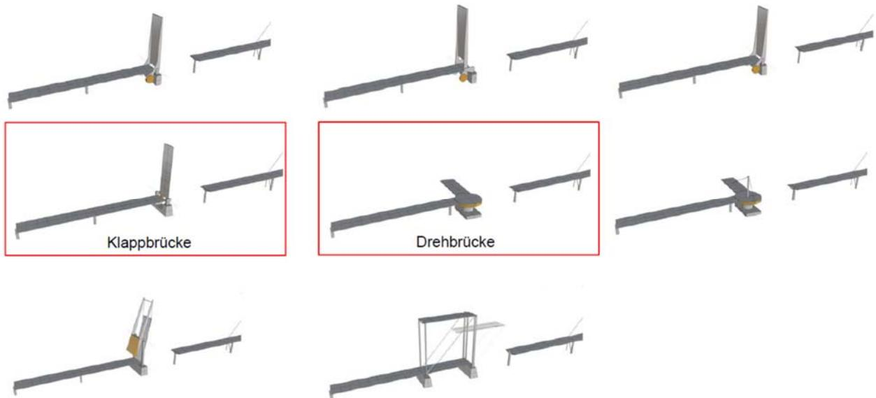
Quelle: Varianten Öffnungsmechanismen bewegliche Brücke ARGE sbp und Inros Lackner SE
