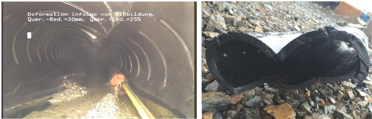
Abbildung 14: Beispielaufnahme eines Scheitelbruchs nach Deformation
