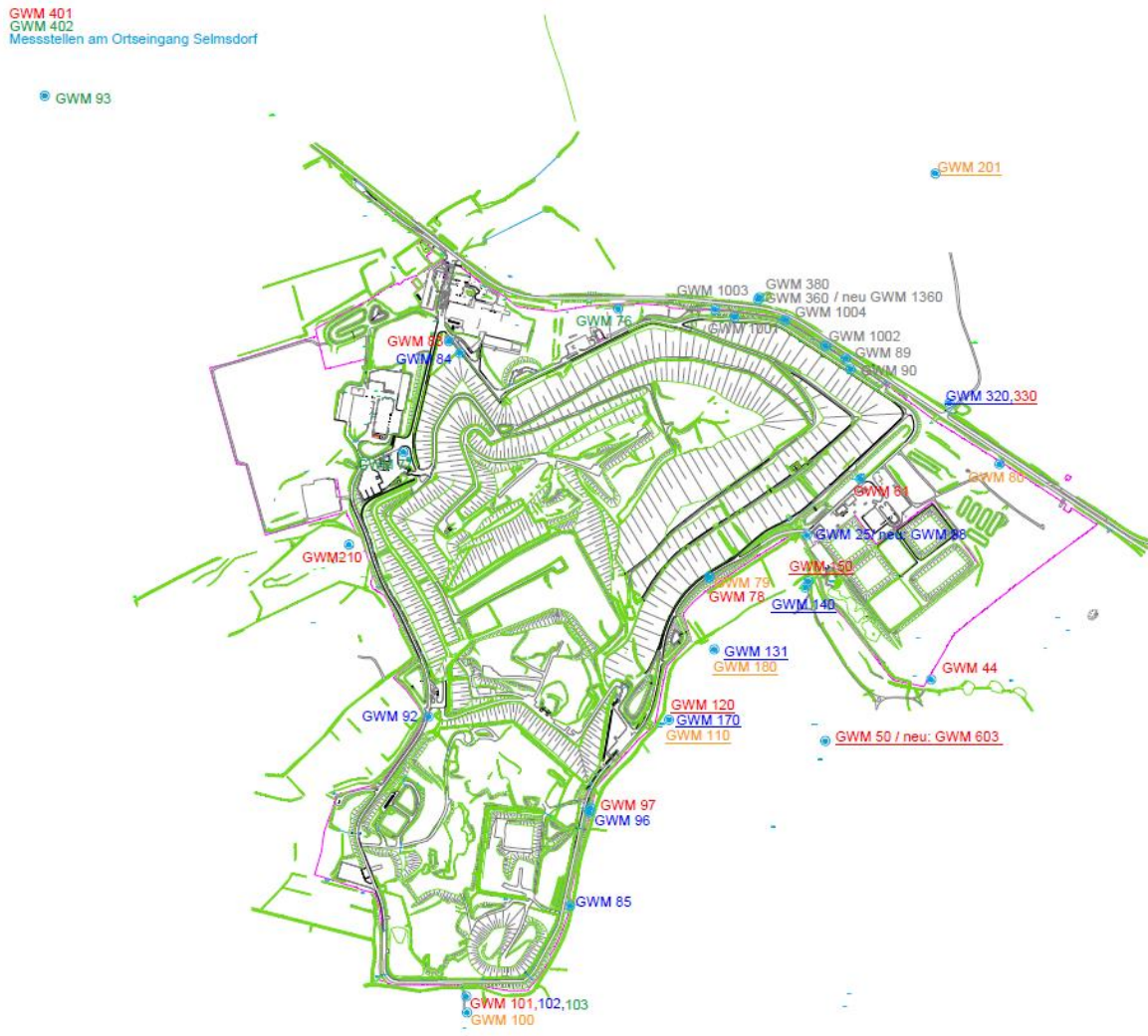
Abbildung 23: Grundwassermessstellennetz der Deponie Ihlenberg (rot: GWL 1.1, blau: GWL 1.2, gelb: GWL 1.3, grün: GWL 3, grau: Sondermessnetz Bockholzberg (detaillierte Darstellung s. Anhang 3.4)
