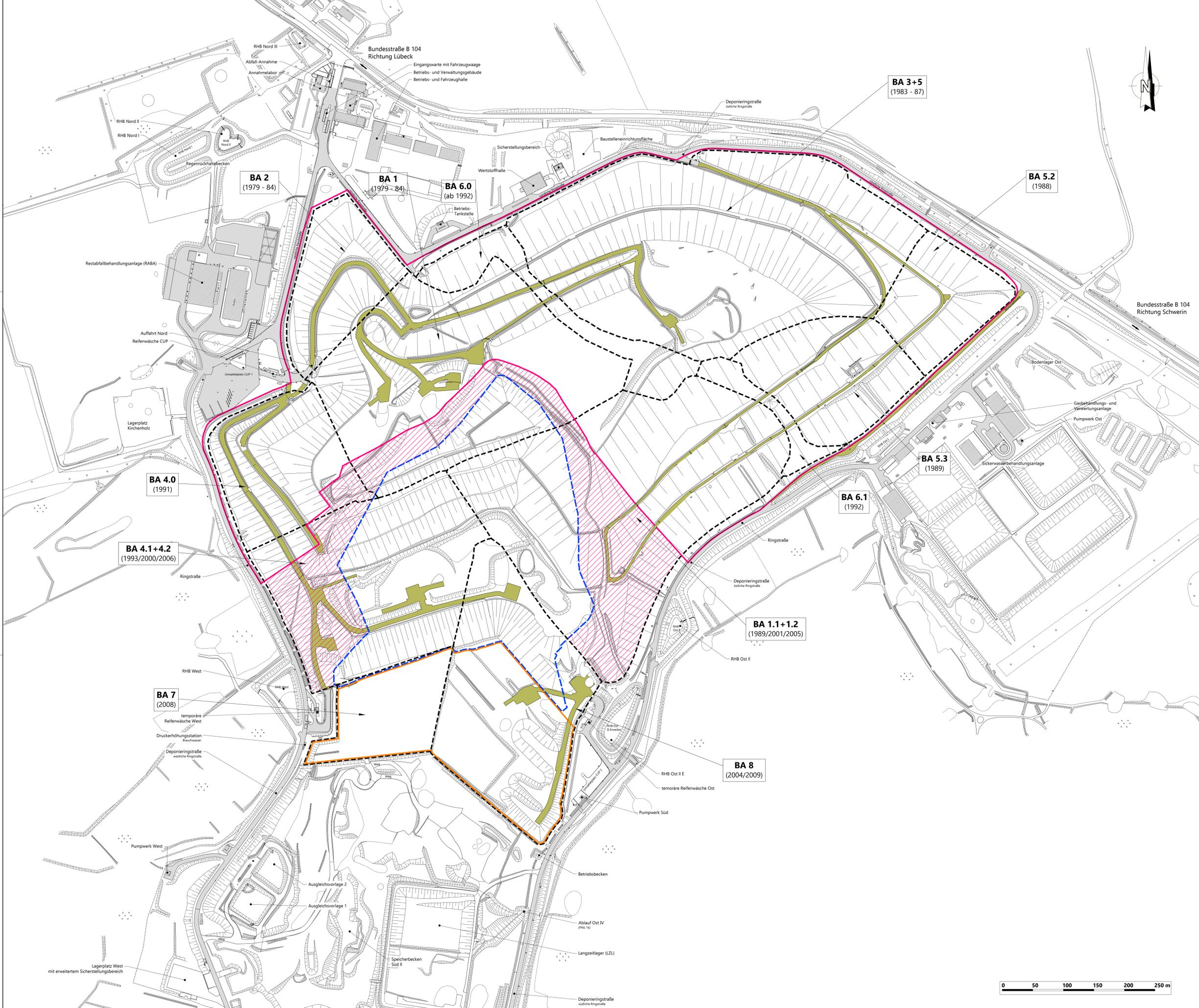
Schematische Übersicht Deponieabschnitt (DA), unterhalb der MFA
