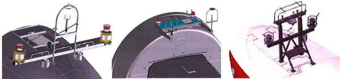
**Abb. 1: Befeuerungsleuchten auf der Gondel, Tropfenform (links) und Kompaktformen (mitig und rechts)**
