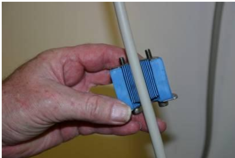
Abbildung 7-56: Korrekter Sitz des Dichtungsmoduls
