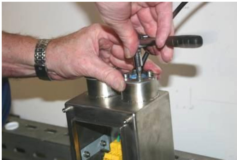
Abbildung 7-49: Festziehen der Schrauben am Dichtungskeil
