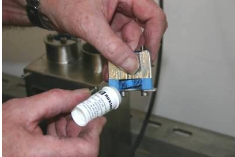
Abbildung 7-48: Die blauen Gummitteile des Dichtungsmoduls werden geschmiert
