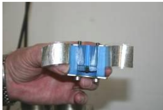
Abbildung 7-43: Entfernen des inneren Schutzbandes
