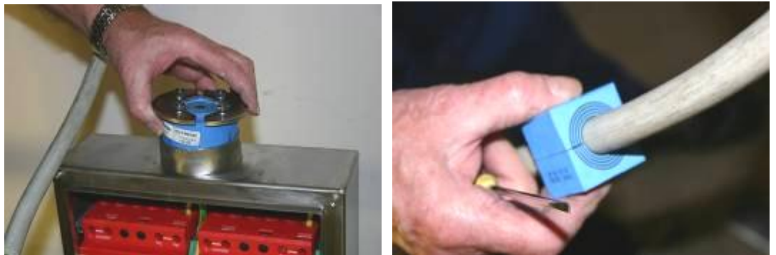
Abbildung 7-64: Entfernen und korrekte Anpassung des Dichtungsmoduls
