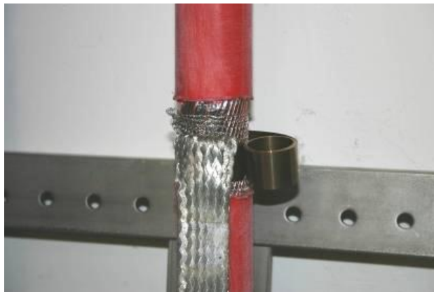
Abbildung 7-11: Umgebogene und über die erste Windung der Verbindungsfeder gebogene Kupferlitze
