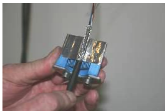
Abbildung 7-47: Korrekter Sitz der Metallfolie
