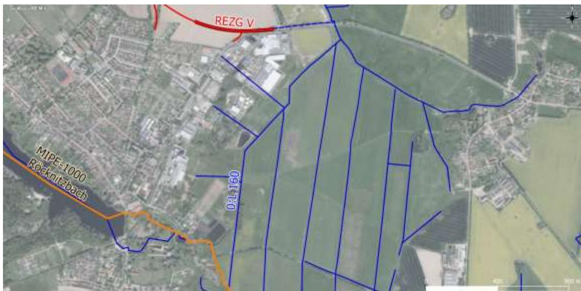
Abbildung 4: Darstellung der Oberflächengewässer, die für die Einleitung des Straßenwassers des REZG V relevant sind (geplante Trasse = rot, Straßengräben B110 = blau gestrichelt, nicht berichtspflichtige Gewässer = blau, Trasse OU Dargun = rot)
