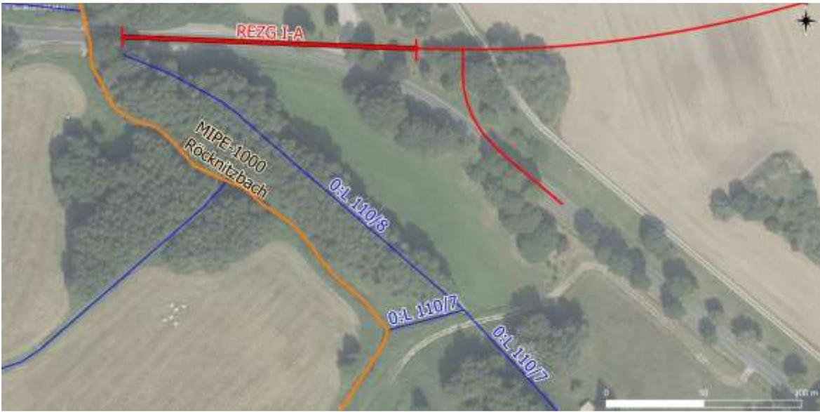
Abbildung 3: Darstellung der Oberflächengewässer, die für die Einleitung des Straßengewässers des REZG I-A relevant sind (geplante Trasse = rot, nicht berichtspflichtige Gewässer = blau, Trasse OU Dargun = rot)
