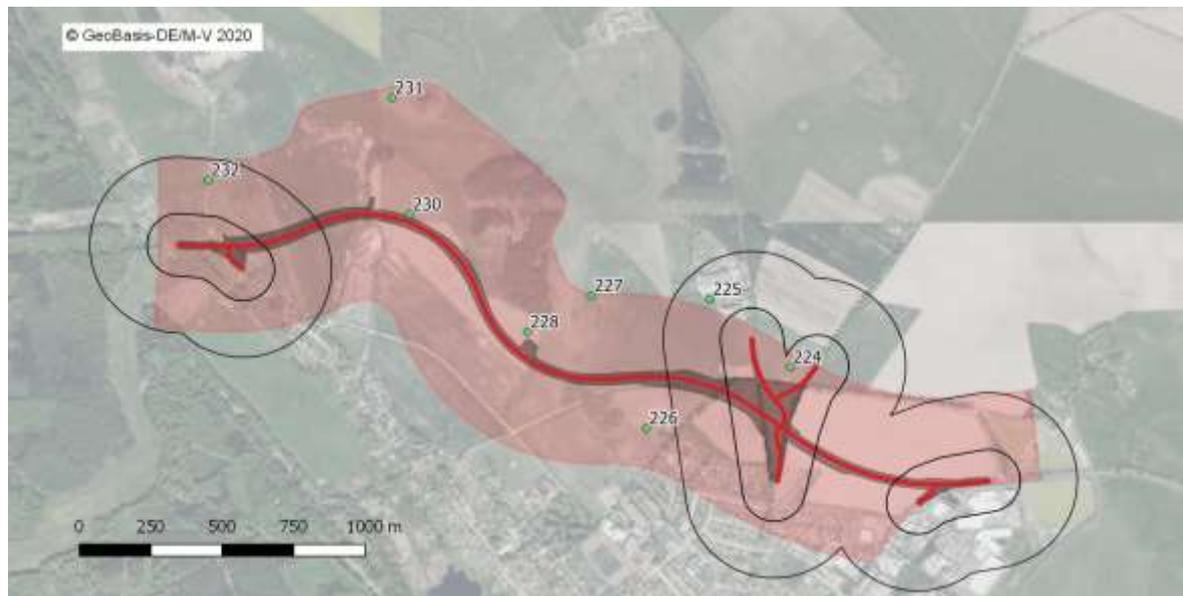
Abbildung: 100 m- und 300 m-Puffer um Trassenabschnitte bei denen die Wirkungen zwischen Bestand und Planung gleich sind. Das Revier ID 224 liegt innerhalb des 100 m-Puffers und weist keine Zusatzbeeinträchtigung im Vergleich zum Ist-Zustand auf.
