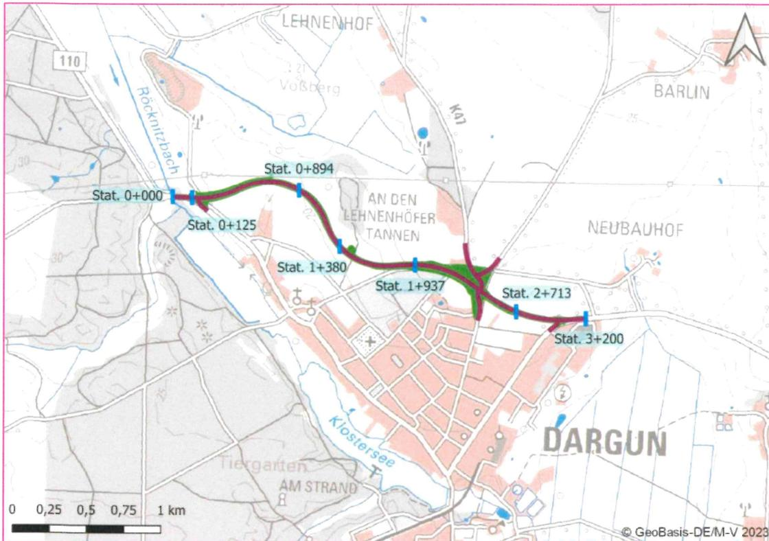
Abbildung 2: Räumliche Einordnung des Bauvorhabens (lila) mit Regeneinzugsgebieten sowie Darstellung des Baufeldes (grün)
