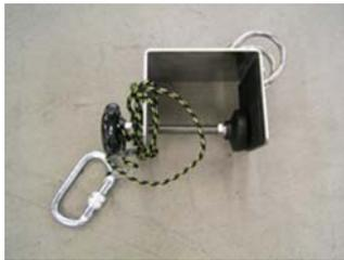
Abb. 22 U-förmiger Kantenschutz
