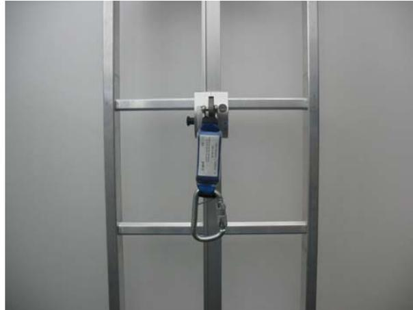
Abb. 8 Fallschutzläufer
