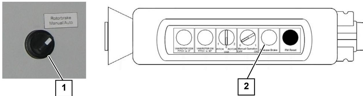
Abb. 19 Bedienelemente für manuellen Betrieb der Rotorbremse
