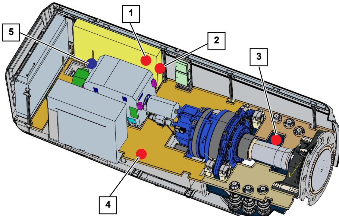
Abb. 13 Not-Halt-Schalter und Ausschalter MS im Maschinenhaus
