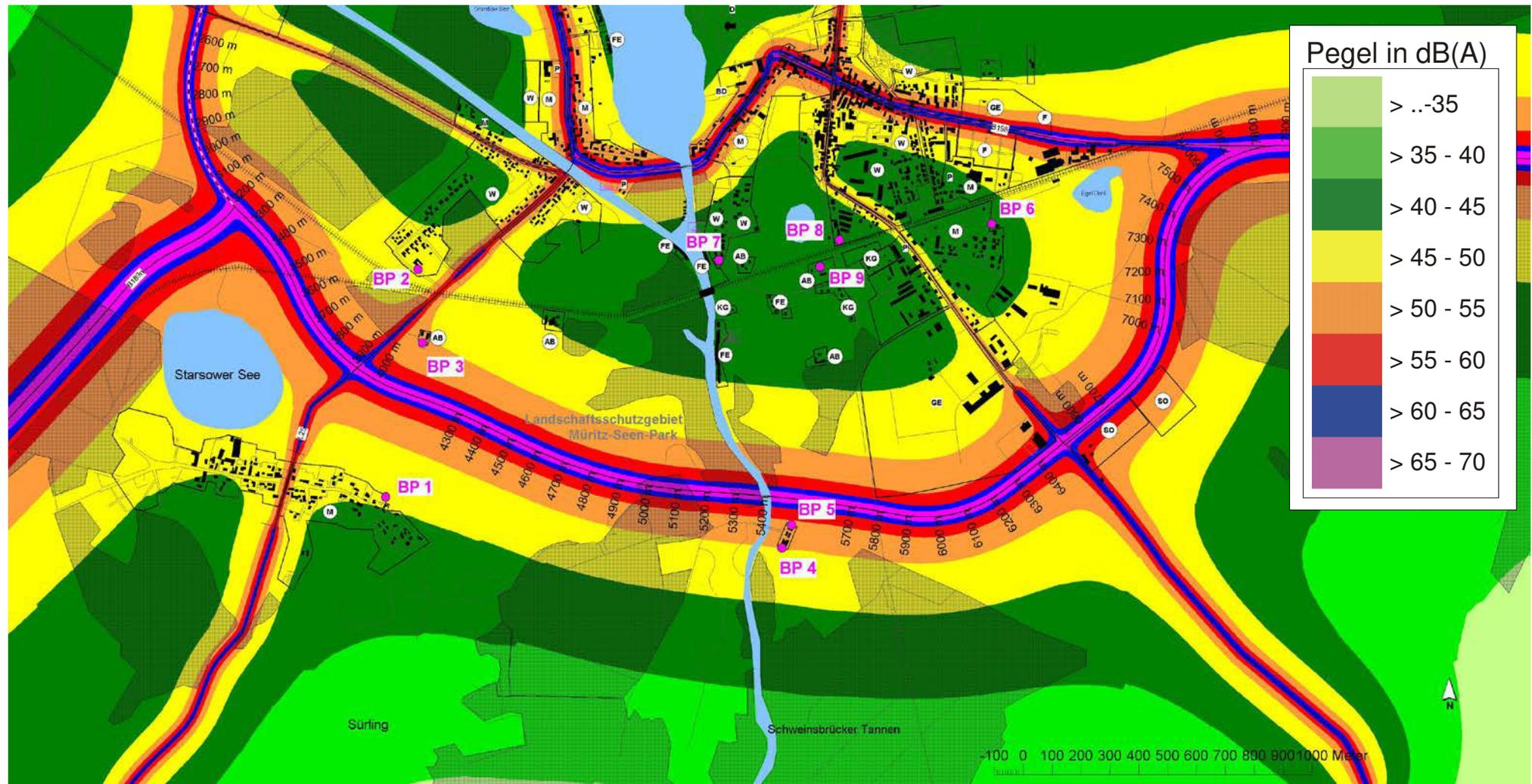
**Abb.7-7 :** Flächenhafte Immissionspegelverteilung – Trassenvariante V3a - Tagzeitraum
