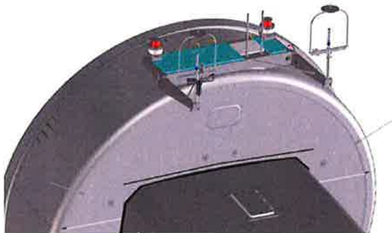
Abb. 2: Befuerung auf der Gondel EP3
